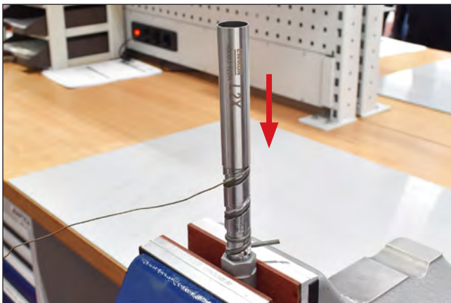
Abbildung 61: Thermofühler aufwickeln, Schutzrohr nachschieben
